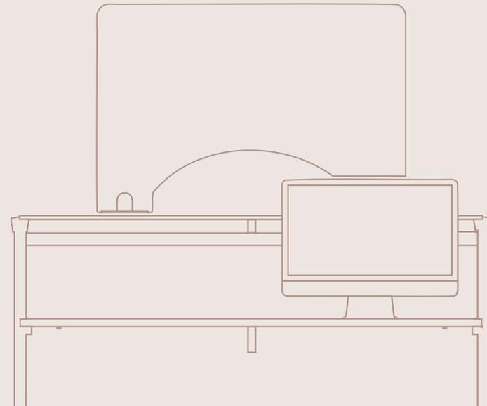
Mampara de protección autoportante fabricada en metacrilato transparente de espesor 5 mm y mecanizada con cantos redondeados.
