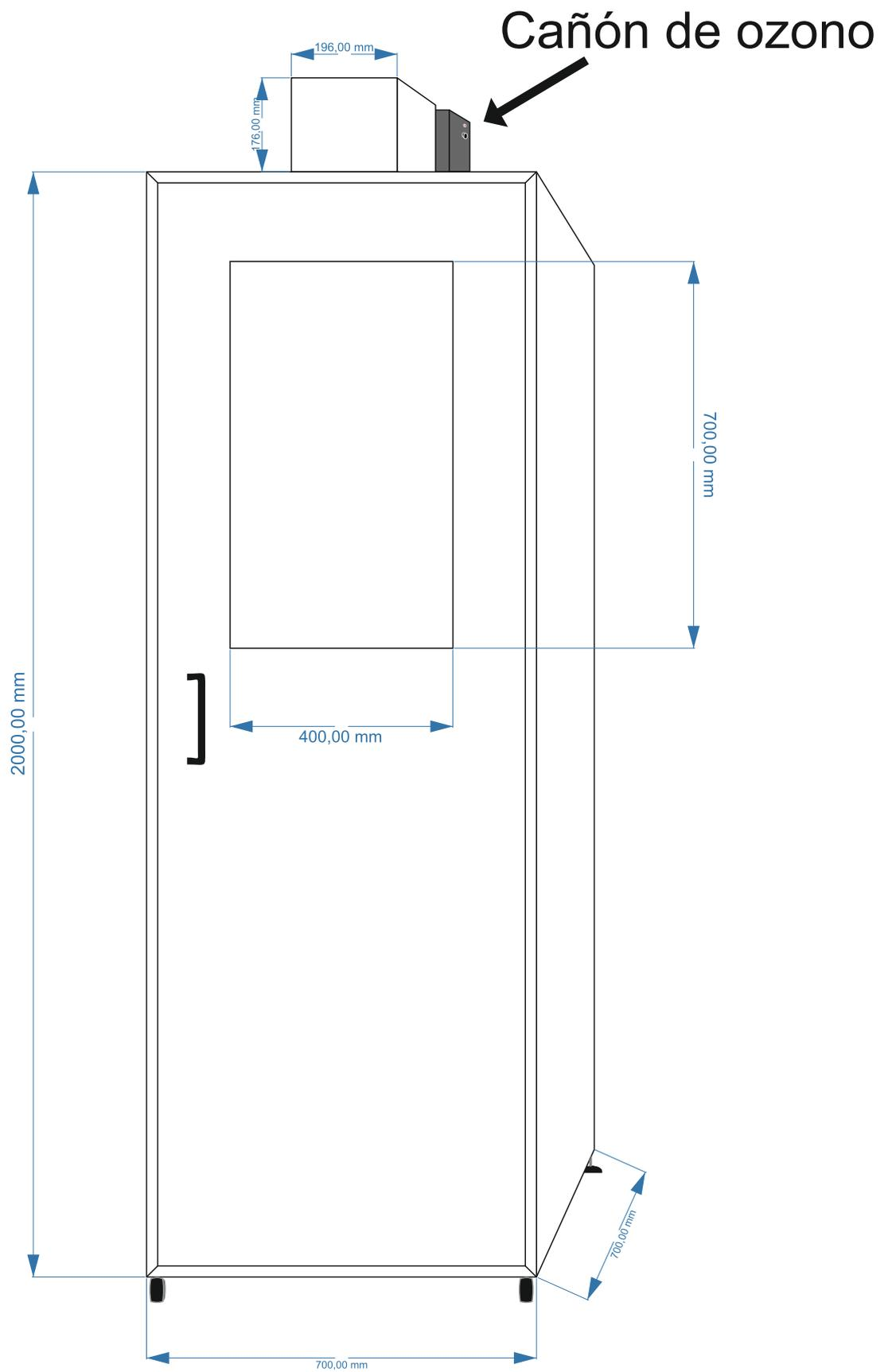
Cabina fabricada mediante estructura de aluminio interior y revestida mediante panel composite.
