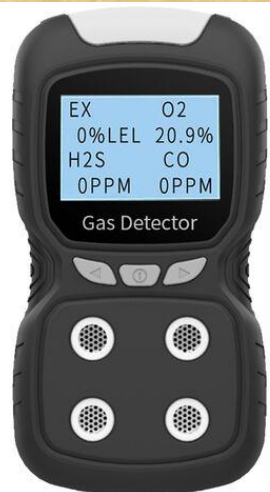
Medidor portátil de gases
